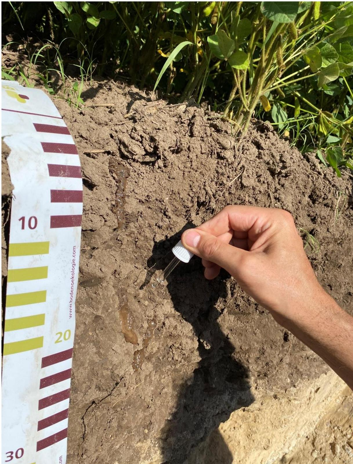
Foto 5: Carbonattest mit 10%iger Salzsäure
