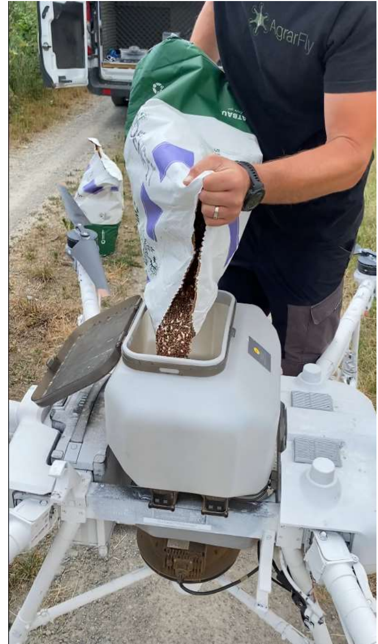
Befüllung des Saatgutbehälters der Drohne. Für die Drohnensaat können unterschiedliche Mischungen mit entsprechenden Saatmengen ausgebracht werden.
