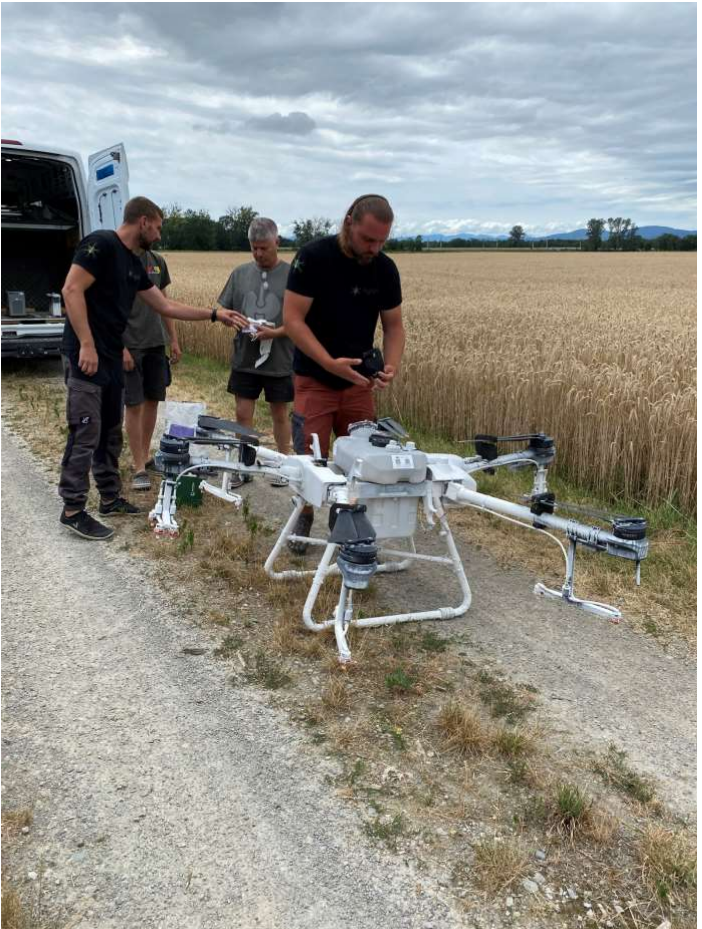
Hier ist auf der Drohne der Behälter für die Flüssig-Applikation mittels Düsen montiert.
