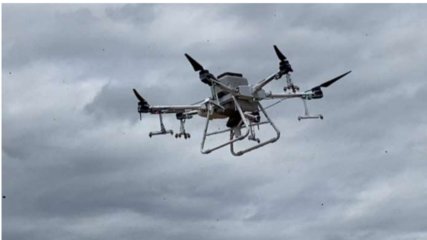
Vollautomatische Saatgutverteilung ca. 4 m über dem Boden mit 8 m Streubreite.
