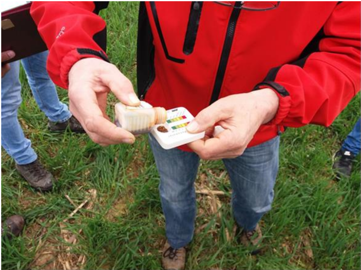
Foto ©Winkovitsch: pH-Wert-Bestimmung zur Kalkbedarfsermittlung
